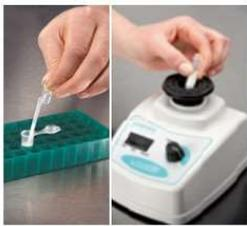
将200ul冷牛奶添加到 Afla M1-V试纸条瓶中。旋涡震荡3次，每次5秒。
