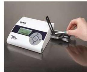
将已处理的试条插入 Vertu检测仪中，按中心按钮进行读数
