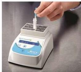
将Afla M1-V试纸条放入样品瓶中，并将样品瓶在40°C的培养箱中放置10分钟。
